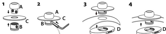
**1+2** Kopf **A** mit Sicherungsfaden
